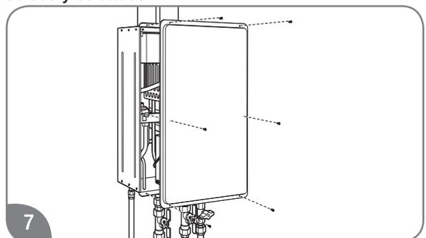
7 Vuelva a colocar la cubierta delantera.
