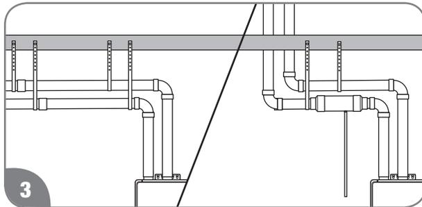
Asegure los tramos verticales y horizontales, como se describe en la página 35. La instalación requiere soportes verticales cada 1.2 m (4 pies) en los tramos de tubería vertical, después de cada transición horizontal a vertical, y después de cada codo.
