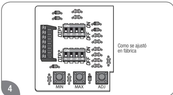
4 Este bloque de interruptores completo sale ajustado de fábrica en la posición OFF (hacia abajo).
