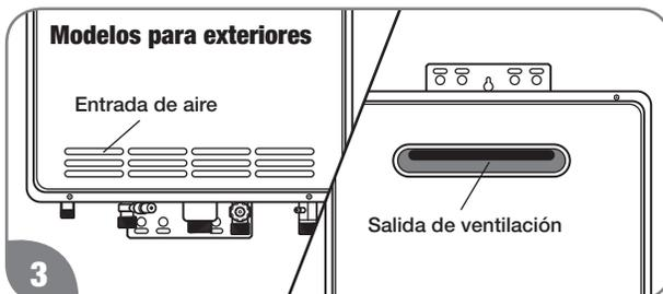
3 Revise la entrada y la salida de aire para verificar la ausencia de obstrucciones y/o residuos.
