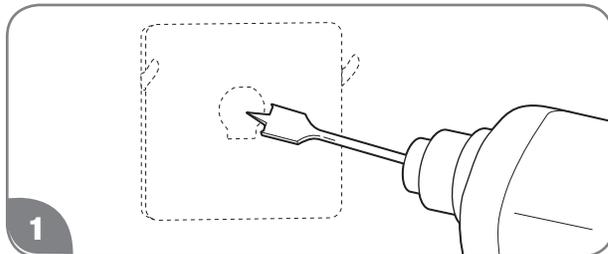
Taladre un agujero de 25 a 38 mm (1 a 1 1/2 pulg.) en la ubicación propuesta para el control. Instale el cable de control entre la ubicación del control remoto y el calentador de agua.
