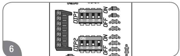
6 Si la altitud está por encima de los 1650 m (5400 pies) y por debajo de 2590 m (8500 pies), cambie el cuarto interruptor del bloque de interruptores a la posición ON (hacia arriba).
