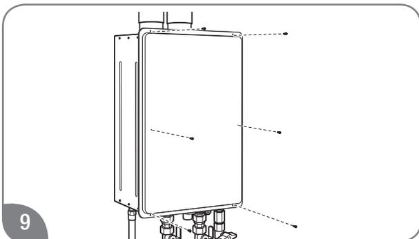
9 Vuelva a colocar la cubierta delantera.
