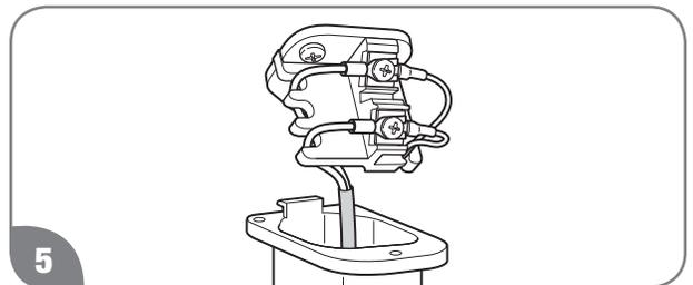
5 Asegure el cable de extensión del control remoto en la ranura situada en el lateral de la base de conexión.
