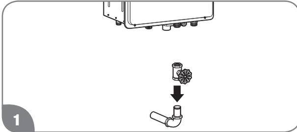
Instale una válvula de paso para el agua fría cerca de la tubería de entrada en el calentador de agua. Esta válvula se utilizará para tareas de mantenimiento y drenaje.
