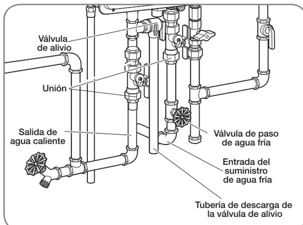
Un extremo de la tubería de descarga de la válvula de alivio se conecta al tubo de salida de agua caliente como se muestra arriba. El otro extremo de la tubería debe instalarse hacia un desagüe adecuado para evitar que un aumento de la presión del agua provoque daños en el calentador.
