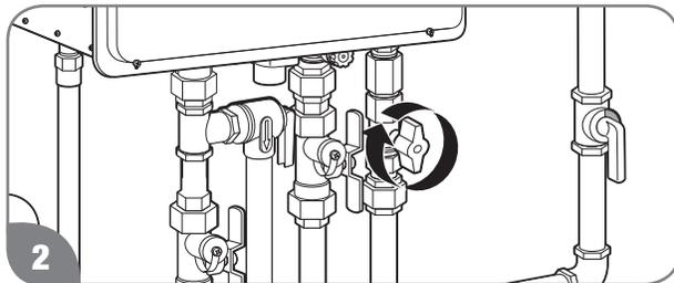
2 Gire en sentido horario la válvula de paso de gas del calentador de agua, hacia la posición APAGADO. Esta válvula está ubicada fuera del calentador de agua. Espere 5 minutos para eliminar el gas remanente. Si no detecta olor a gas, continúe con el paso 3.
