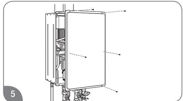
Vuelva a colocar la cubierta delantera.
