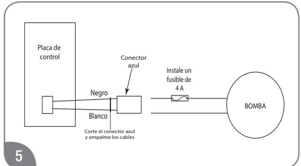
5 Para conectar a la bomba, corte el conector azul, empalme los cables y agregue un fusible de 4 A en el cable de la fase que alimenta la bomba. El juego de bomba de recirculación de Rheem incluye un conector Molex y un fusible de 4 A, por lo que no es necesario empalmar los cables.
