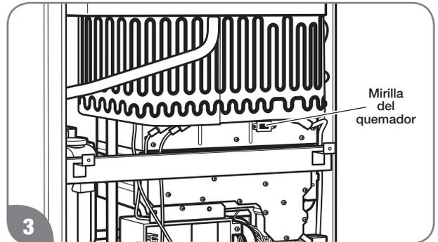
Mientras el calentador de agua está funcionando, inspeccione las llamas del quemador principal a través de la mirilla del quemador. Las llamas deben ser azules con el quemador principal encendido.
