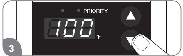
3 Presione el botón de ajuste ▼ repetidamente hasta que aparezca 38°C (100°F) o 29°C (85°F) en la pantalla LED. Mantenga presionado el botón ▼ hasta que el número en la pantalla comience a parpadear.
