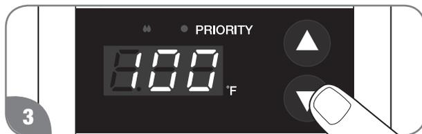
3 Presione el botón de ajuste ↑ repetidamente hasta que aparezca 38°C (100°F) en la pantalla LED.
