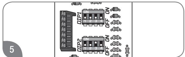
5 Si la altitud está por encima de los 610 m (2000 pies) y por debajo de 1650 m (5400 pies), cambie el tercer interruptor del bloque de interruptores "DIP 2" a la posición ON (hacia arriba).
