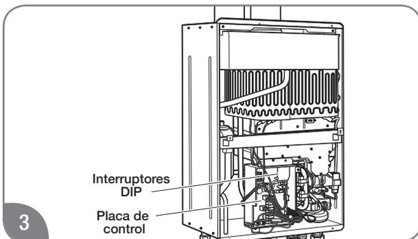
3 Busque el bloque de interruptores DIP 2 en la parte superior derecha de la placa de control; es el bloque inferior, etiquetado como "DIP 2".
