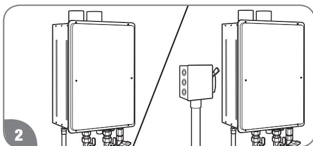
Asegúrese de que haya una toma de corriente o un suministro eléctrico adecuado (120 Vca / 60 Hz) disponible y cercano a la unidad. Los modelos con ventilación directa vienen con un cable de alimentación de 1.8 m (6 pies), mientras que los modelos para exteriores requieren de una conexión eléctrica fija o la instalación de un cable con el enchufe correspondiente.
