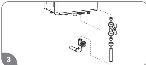
Instale una válvula de servicio en el extremo de la tubería de suministro de agua fría y conéctela a la entrada de agua en el calentador de agua.
