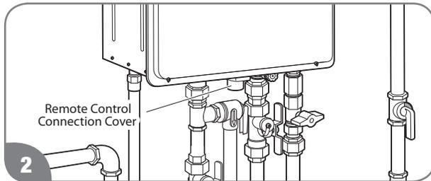
2 Afloje el tornillo situado en la tapa de conexión del control remoto. La tapa de conexión es de plástico blanco.
