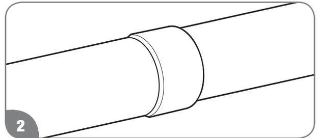
Conecte el extremo hembra de la siguiente sección del tubo de ventilación al extremo macho del tubo de ventilación de 2 pulg. / 3 pulg. Vea "Aplicación de cemento en las uniones" en la página 40.
