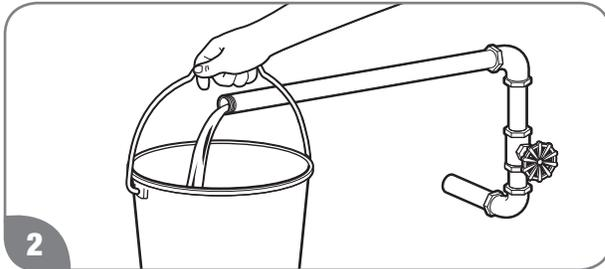
Antes de conectar la tubería de agua al calentador de agua, abra la válvula de paso. Deje correr el agua hasta que haya expulsado todos los contaminantes (arena, suciedad, aire, residuos de sellador, etc.)
