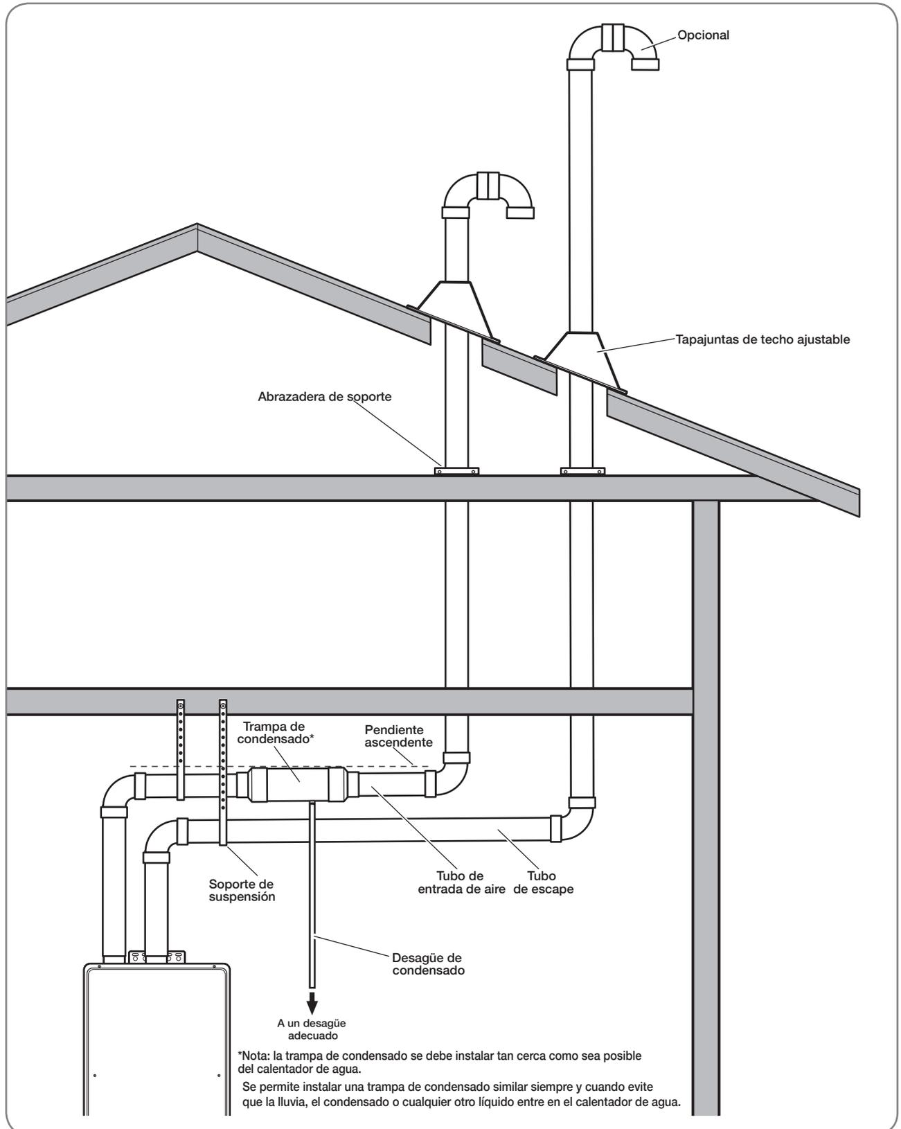
\*Nota: la trampa de condensado se debe instalar tan cerca como sea posible del calentador de agua.
