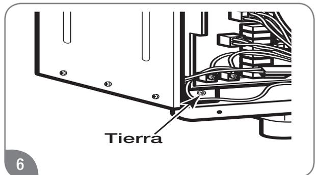
6 Conecte el cable de tierra de la bomba a un tornillo en la base del gabinete del calentador de agua.
