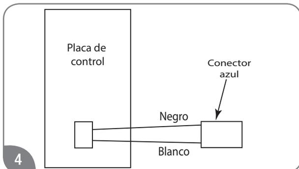
4 El mazo de cables de la bomba de recirculación está incluido en el mazo de cables de la placa de control. En él, encontrará un conector azul con un cable negro y uno blanco.
