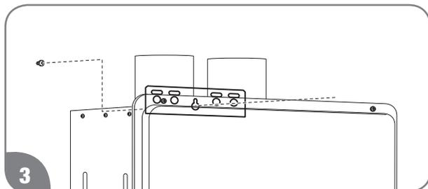
Coloque el soporte de montaje superior e instale el tornillo de montaje central sin ajustarlo hasta el fondo. La separación entre la cabeza del tornillo y la pared debe ser de aproximadamente 3 mm (1/8 pulg.) Cuelgue el soporte superior en el tornillo.
