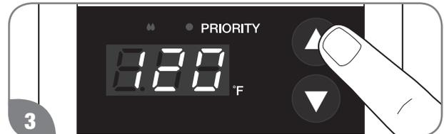
3 Presione el botón de ajuste repetidamente hasta que aparezca 49°C (120°F) en la pantalla LED. Mantenga presionado el botón hasta que "120" comience a parpadear en la pantalla.
