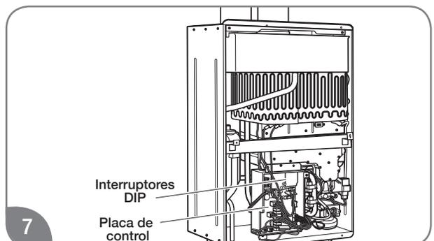
7 Busque el bloque de interruptores DIP 2 en la parte superior derecha de la placa de control; es el bloque inferior, etiquetado como "DIP 2".
