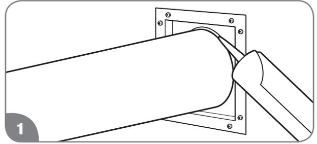
Aplique sellador de silicona o masilla de silicona / látex para sellar el tubo de ventilación con el acoplamiento. Esto permitirá desmontar las piezas en el lugar para la inspección y limpieza anual. Selle toda la circunferencia de la tubería donde atraviesa la placa de pared y donde está asegurado a la estructura.
