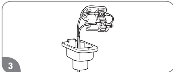
3 Conecte los cables de extensión del control remoto desde el control remoto a los bornes de conexión del control remoto.
